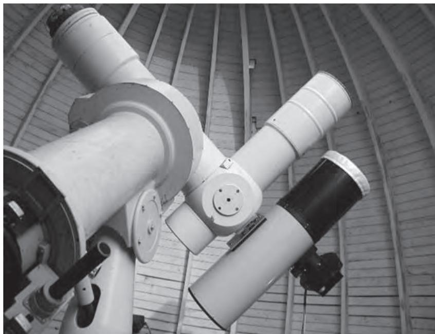
*Рис. 1.* Телескоп ГАС-250 на монтировке 15-см рефрактора
