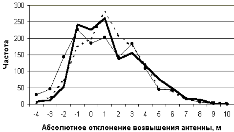
Рис. 6. Полигоны частот средних абсолютных отклонений возвышений антенны над поверхностью референц-эллипсоида за 7 октября (пунктирная линия), за 8 октября (тонкая линия с маркером) и за 9 октября (жирная линия)
